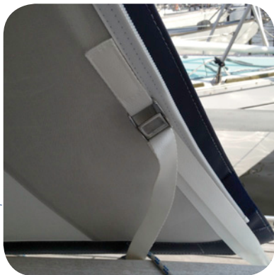
Spanngurte werden aus hochwertigem Polyesterband mit Edelstahlspannschnalle gefertigt.
