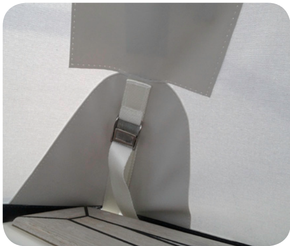
Der Arbeitsbereich der Spannelemente wird grundsätzlich verstärkt. Ob an der Sprayhoodachterkante oder in den Ecken bei den Anschlussteilen.
