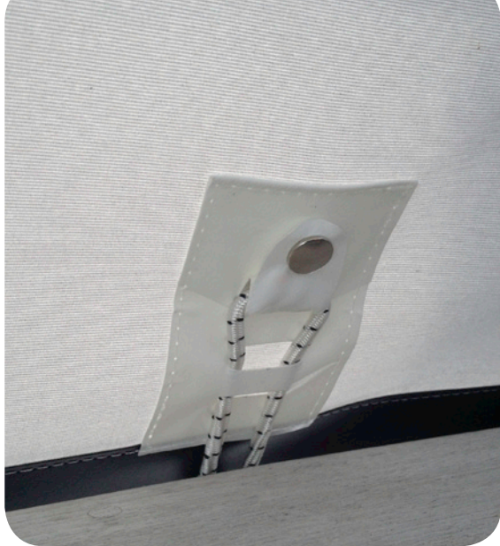
Im Heckbereich bei Anschlußelementen wird mit Spanngummis gearbeitet, um die Montage zu erleichtern.
