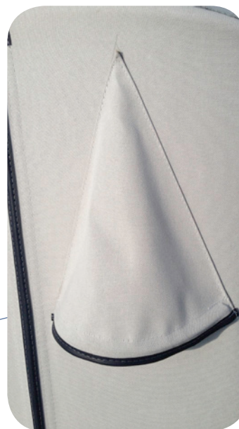
Lüftungshutzen im Heckbereich in der Stb. + Bb. Seite, um ein Über- und Unterdruck erzeugen zu können.
