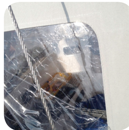
Bei der Erstausrüstung sind alle Fenster mit einer Schutzfolie versehen, um Verarbeitungsspuren zu vermeiden.
